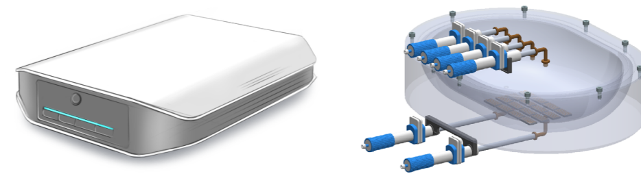
Abb. 14: Beispiele für eine integrierbare, geschlossene Einheit, in der die individuellen Zellen von Patientinnen und Patienten prozessiert werden (Bildquelle: links FhG IPA, rechts FhG IPK)
