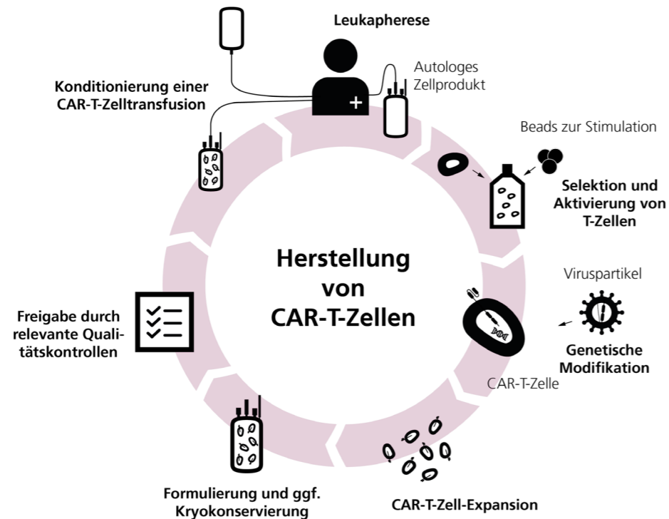
Abb. 4: Generischer Prozessablauf zur Herstellung von CAR-T-Zellen (Bildquelle: FhG IPA, basiert auf Referenz 30 )
