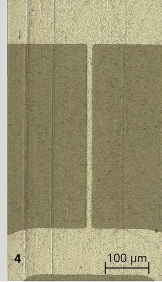
1-2 *Stahling mit Sensorstrukturen (1) und Mikroskopaufnahme der 10 µm dicken Sensorstruktur (2).*
