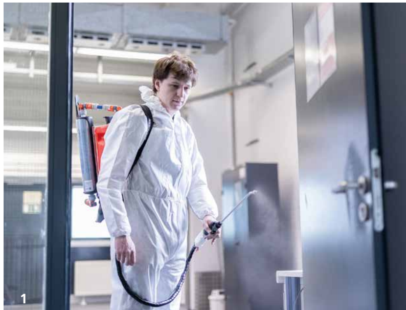
Mobile Rückenspritze zur effizienten Erzeugung von ozoniertem Wasser zur Flächendesinfektion.
