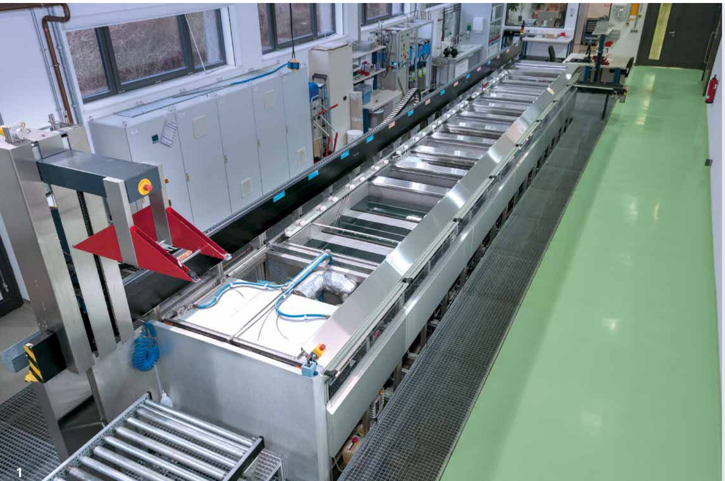
Mehrkammeranlage für die wässrige Reinigung am Fraunhofer IST mit hoher Reproduzierbarkeit und Flexibilität bezüglich der zu reinigenden Materialien.
