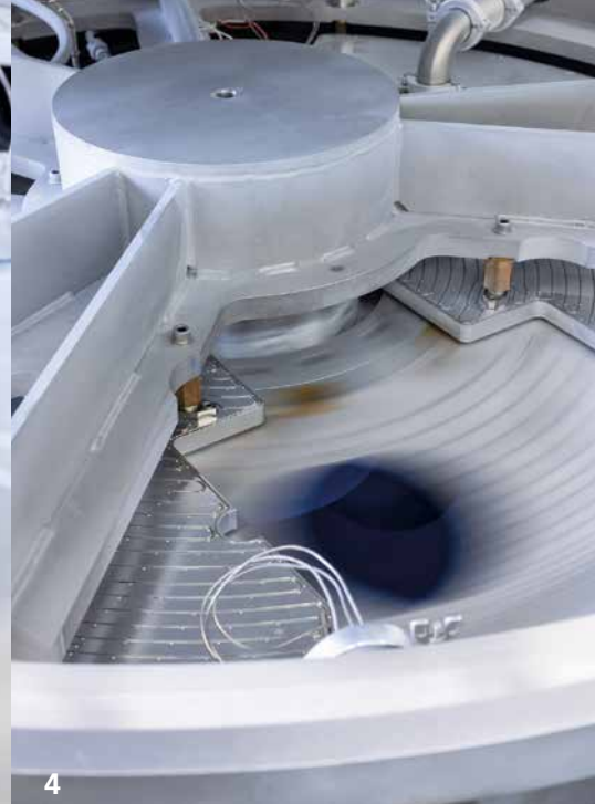
Örtliche Atomlagenabscheidung: Blick auf den rotierenden Drehteller unter- halb des Heizblocks im Hybrid-Bereich.
