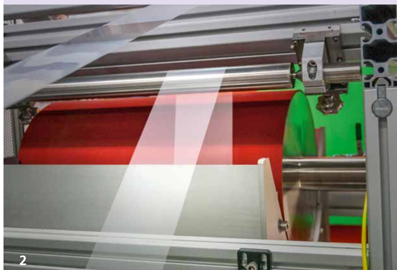
Umsetzung industrienaher Prozesse durch Rolle-zu-Rolle-Beschichtungsverfahren: Aldyne™-Anlage zur kontinuierlichen Funktionalisierung, -Vernetzung und -Beschichtung.
