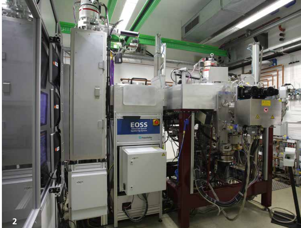
2 Mit dem EOSS®-System können modernste Hochpräzisionsschichten hergestellt werden.
