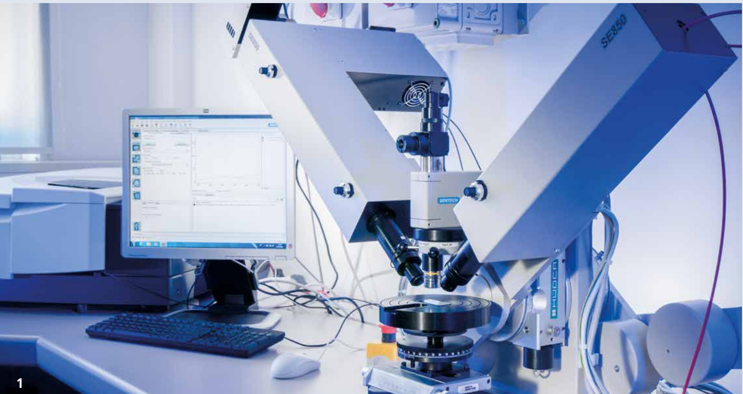
Ellipsometrie zur Bestimmung von Dicken und Dispersionen von Schichten mittels Sentech SE 850 (SENresearch).
