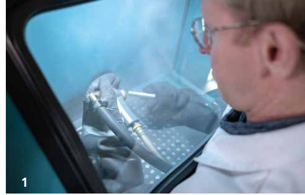
Handstrahlanlage für verschiedenste Strahlmittel.
