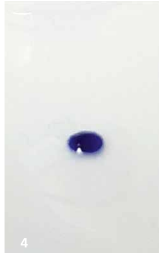
Veränderung des Benetzungsverhaltens einer PE-Oberfläche durch die Behandlung mit der Plasmadüse.
