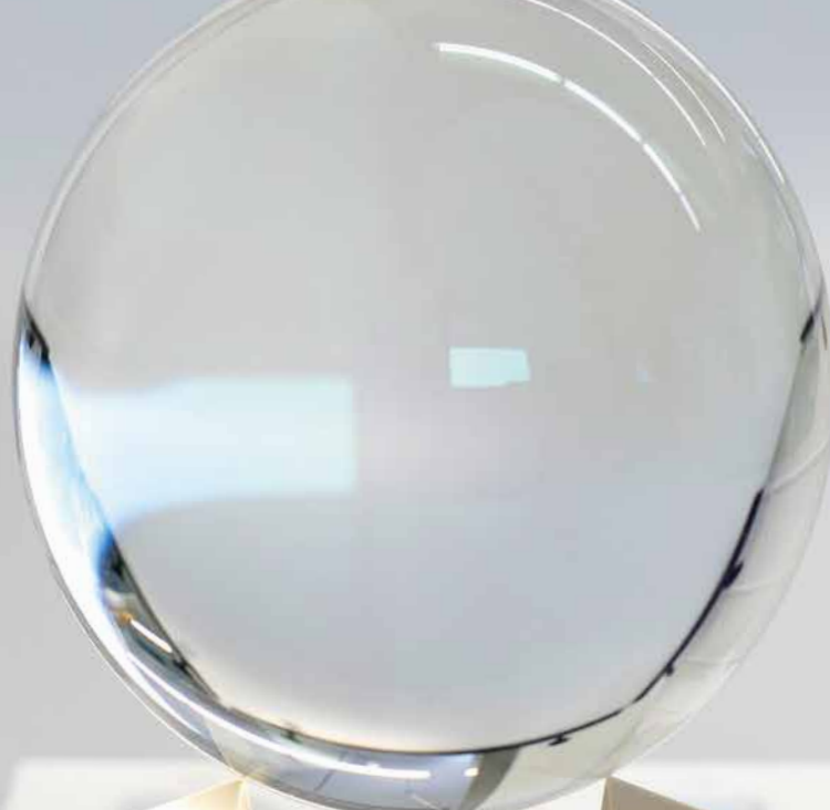
Antireflex-Schichtsystem auf 3D-Objekt, hergestellt mittels Atomlagenabscheidung (ALD).
