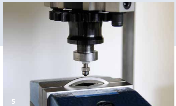
Bestimmung der Ermüdungsfestigkeit von Schichten und Werkstoffen bei Dauerbelastung: Impact-Test beim Prüfen einer Beschichtung auf einem Kolbenring.
