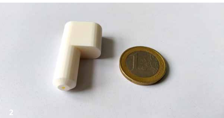
Plasmadüse aus Al_2O_3 -Keramik mit Größenvergleich.
