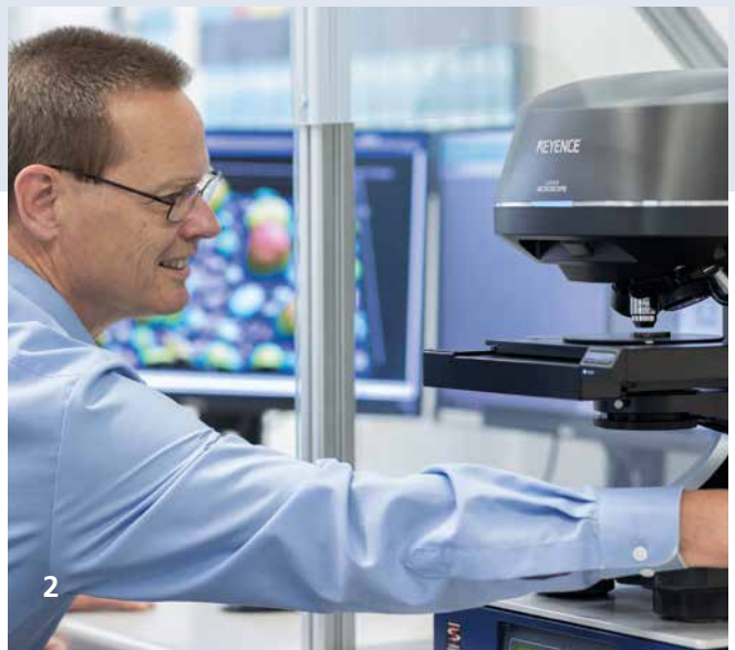
Konfokales Lasermikroskop: Analyse von Batteriepartikeln.
