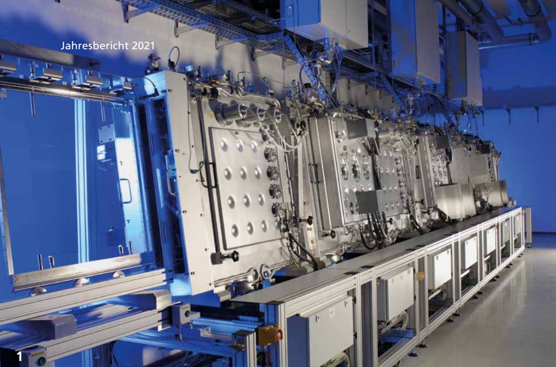
7-Kammer-Durchlaufanlage zur Abscheidung von Silizium und Siliziumnitridschichten mit dem Heißdraht-CVD-Verfahren. Maximale Substratabmessungen: 500 mm x 600 mm.
