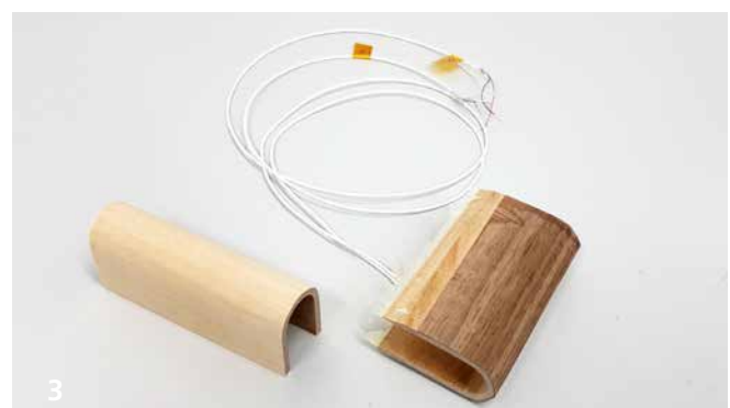
Umgeformtes Furnier mit Sensorintegration.
