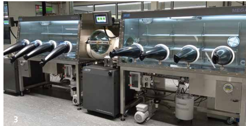
Sichere Zellfertigung mit Gloveboxen im neuen Technikum.
