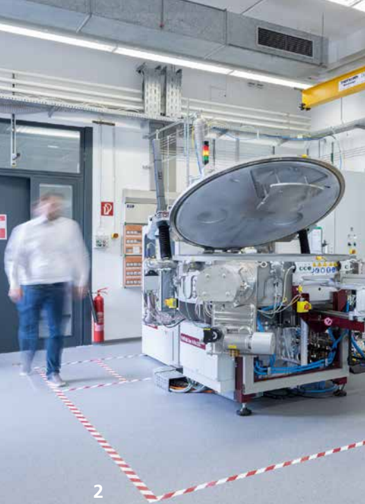
SALD-Beschichtungsanlage FHR Star 400x300 zur thermischen örtlichen Atomlagenabscheidung.
