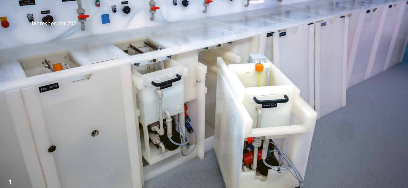
Modulare, prozessgesteuerte Galvanikanlage im 20-l-Maßstab mit integrierter Badanalyse und automatisierter Nachdosierung.
