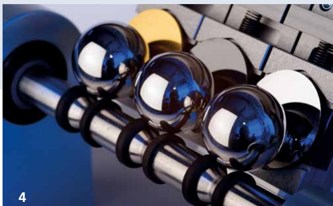
Kalottenschleifgerät mit drei Kugeln zur präzisen Bestimmung der Verschleißbeständigkeit von Schichten und Oberflächen.
