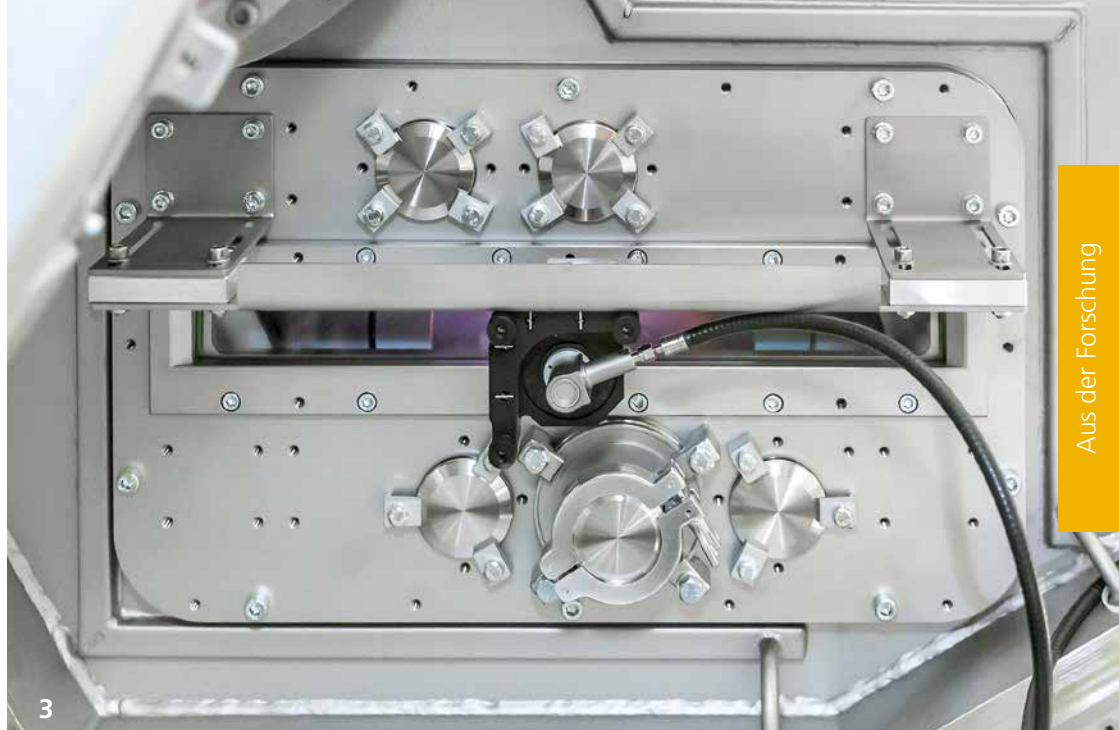
Strahlengang durch die Anlage (links) und Eingangsfenster mit variabler Messposition über dem Substrat (rechts). Foto: VON ARDENNE Corporate Archive
