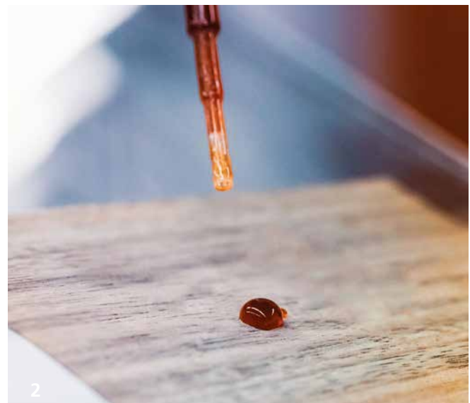
Nachhaltig mittels Atmosphärendruck-Plasmaverfahren beschichtetes Furnier.
