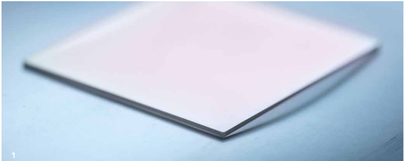
Diamantbeschichtetes Quarzglas mit sehr homogenem Schichtbild.
