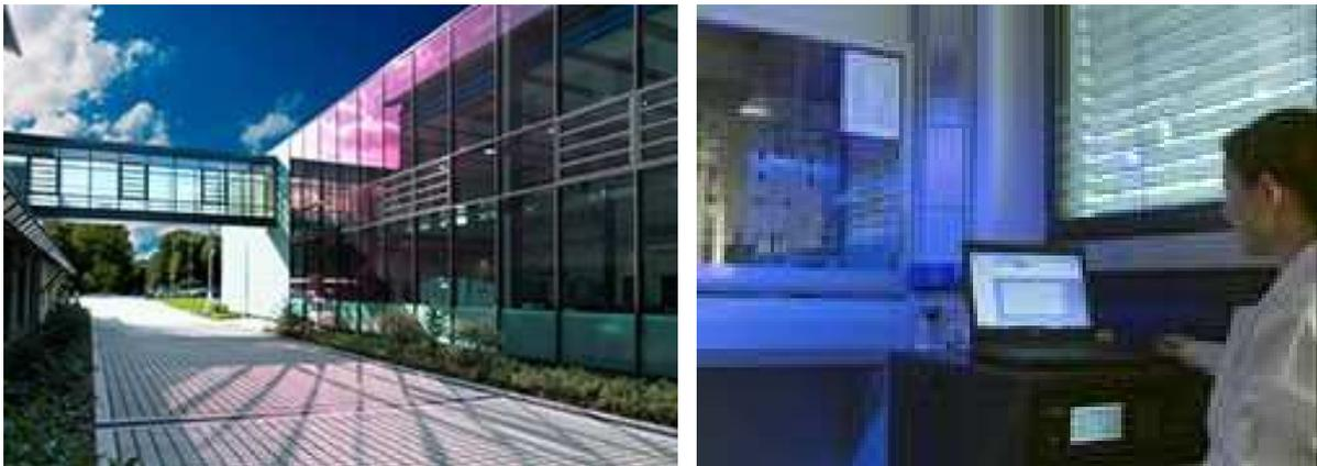
*Abbildung 32: links: Fraunhofer Institut für Schicht und Oberflächentechnik Braunschweig IST; rechts: Messplatz zum NO<sub>x</sub>-Abbau von photokatalytisch aktiven Materialien nach ISO*
